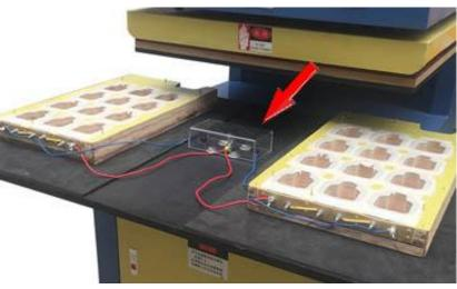
Acrylic cover Acrylic cover isolates the electric connection poles, which can avoid short circuit and also protect operator. मशीन का नाम:- क्रबर मेकिंग मशीन मशीन की कीमत:- 450000 रुपये + 18% जीएसटी + स्थानीय परिवहन वारंटी:- 1 साल वारंटी प्रदाता:- युक्तिराज प्राइवेट लिमिटेड
